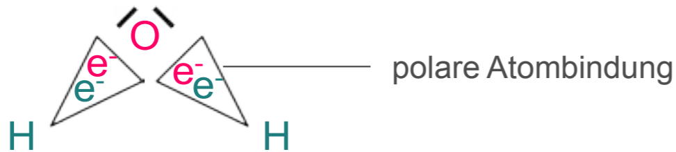
Bild 25: Polare Atombindungen im Wassermolekül
