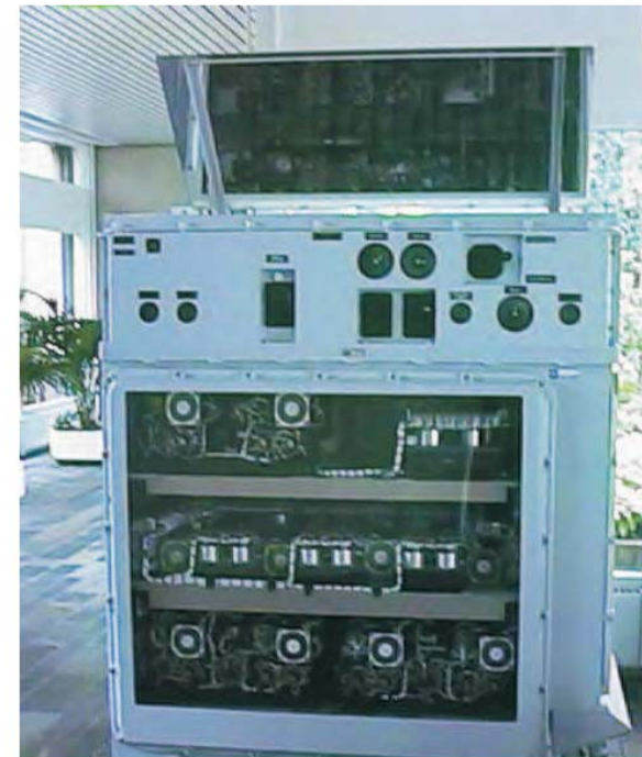
Elektromechanisch vuurleidingtoestel ("rekenaar") Fabrikaat N.V. Hollandse Signaalapparaten, 1952-1960
