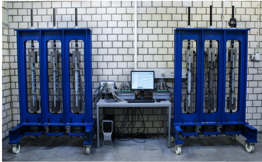
Figure 21 Test rig for extended creep tests (UDE)
