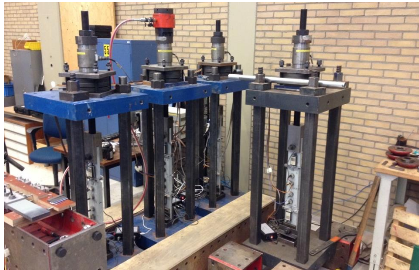
Figure 22 Test rig for extended creep tests (UDE)
