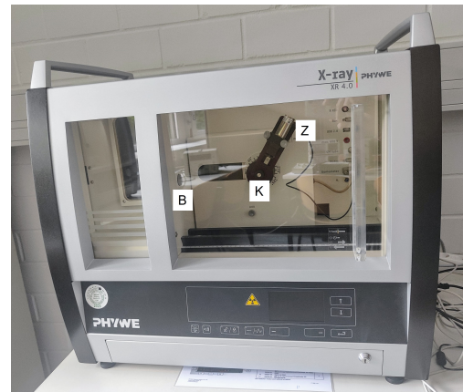
Abbildung 7: Röntgenapparat mit Röntgenröhre Experimentierkammer Blende B Kristall K Zählrohr Z Motorantrieb und Winkelanzeige Display Schubfach mit Zubehör
