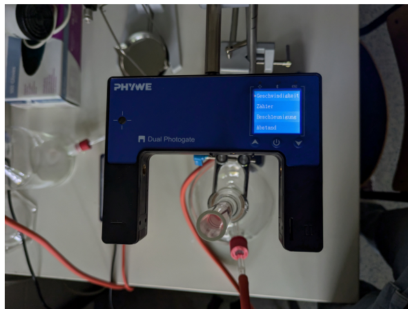
Abbildung 4: Position der Lichtschranke um den Oszillator in einem Rohr.
