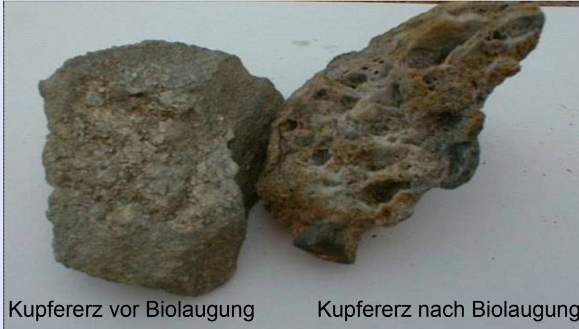
Mit Mikroorganismen werden die Metallatome in den Mineralen zu wasserlöslichen Sulfaten oxidiert
