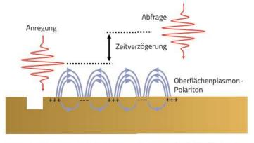
Durch die Rillen in der Goldstruktur kann ein Laserpuls ein Oberflächenplasmon-Polariton anregen, das über die Oberfläche läuft. Mit zeitlicher Verzögerung erfolgt dann die Abfrage.
