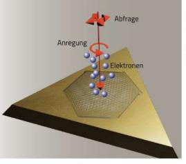
In dieser Struktur lassen sich dank des Rillenmusters SPPs anregen und mithilfe des zweiten Laserpulses Elektronen freisetzen. Durch die Variation der Polarisation des zweiten Pulses kann man das gesamte Vektorfeld rekonstruieren.
