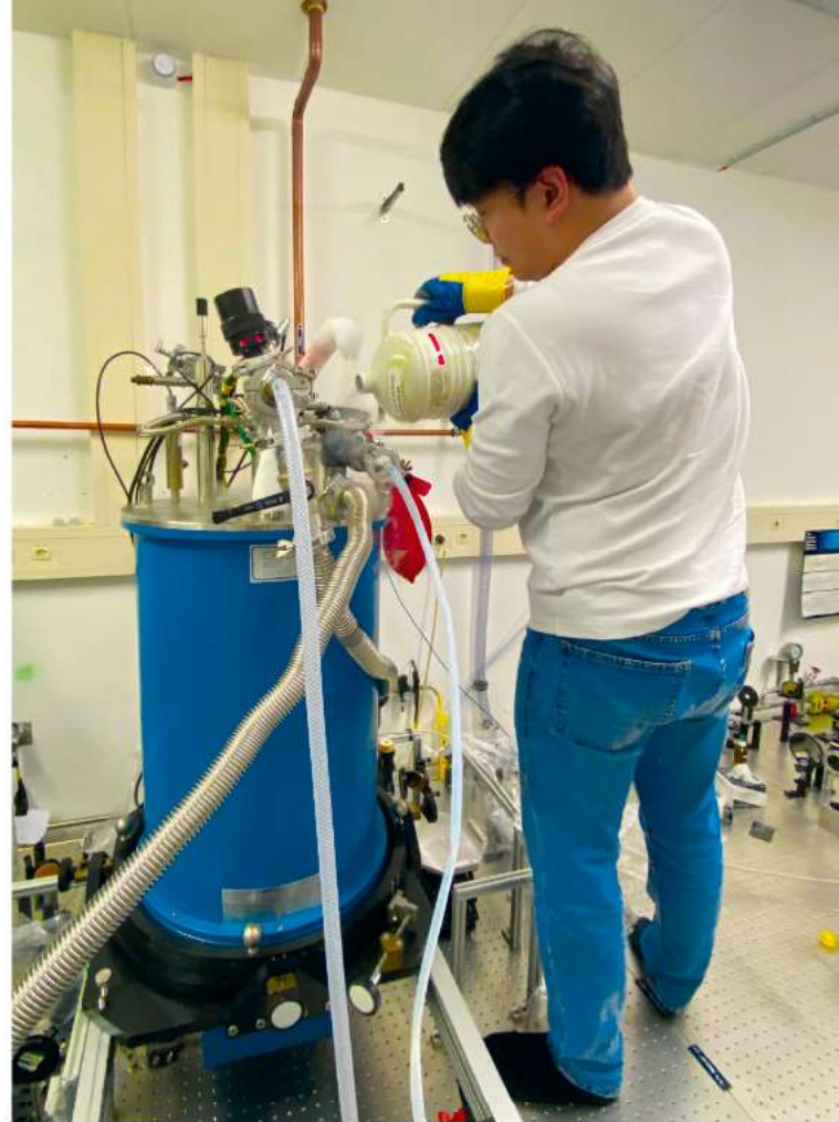
In diesem optischen Magnetkryostat befinden sich die Graphenprobe sowie ein supraleitender Magnet, der mit flüssigem Helium gekühlt wird. Zusätzlich gibt es ein Hitzeschild, das mit flüssigem Stickstoff gekühlt wird. Hier wird dieser gerade nachgefüllt.
